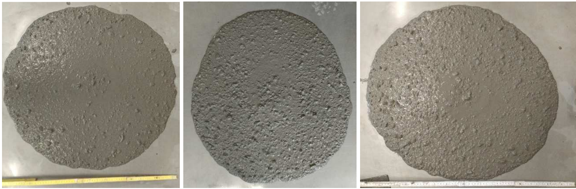
Abbildung 5.6: Fließmaß der Mischungen T31 links (46Min; 70 cm); T32 mitte (47Min; 64cm); T33 rechts (45Min; 67cm)
