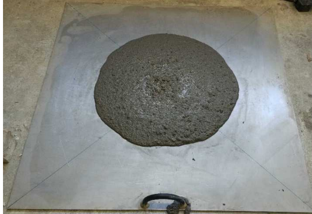
Abbildung 4.7: Ausbreitungsmaß Ausgangsrezeptur (58cm)
