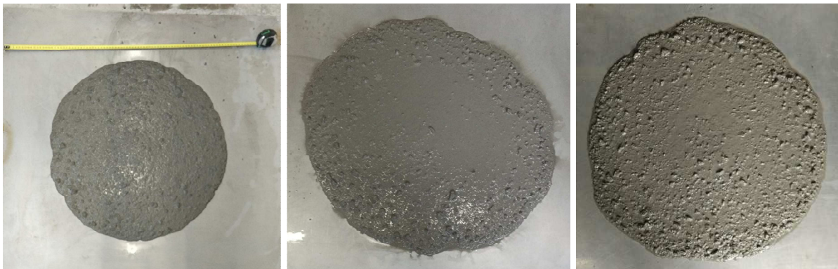
Abbildung 5.3: Fließmaß der Mischungen T21 links (13Min; 62cm); T22 mitte (50Min; 73cm); T23 rechts (52Min; 66,5cm)
