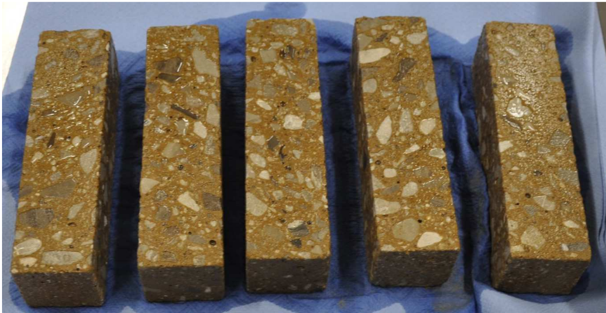
Abbildung 5.14: Probekörper der Rezeptur T61 nach der Essigsäurelagerung
