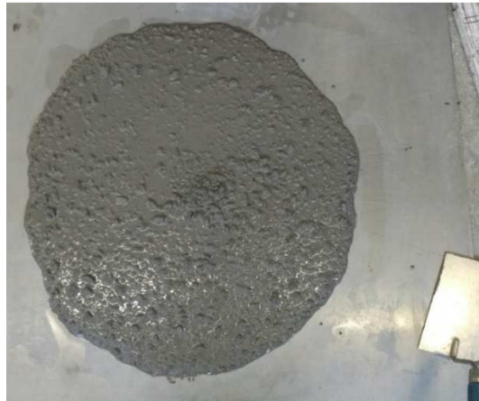
Abbildung 5.15: Fließmaß von 64 cm nach 13 Minuten
