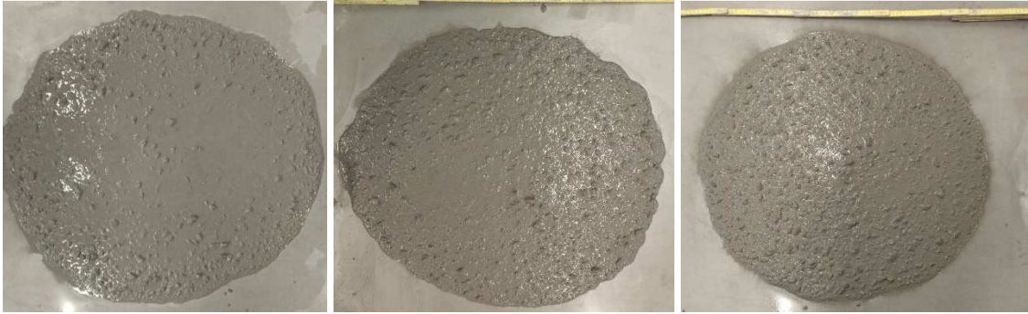
Abbildung 5.7: Fließmaß der Mischungen T43 links (45Min; 73 cm); T54 mitte (30Min; 70cm); T61 rechts (10Min; 69cm)
