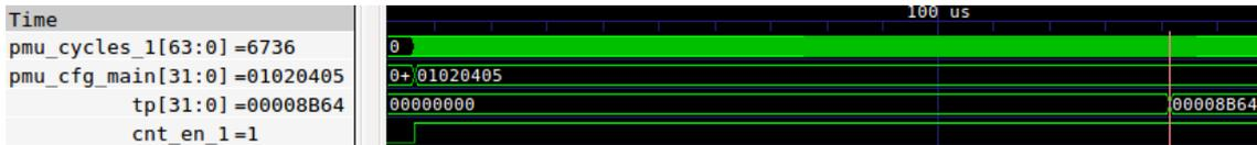
Abbildung 6.4: Die Darstellung des Testfalls `PMU_ALL_COUNTER` in der Simulation in GTKWave.
