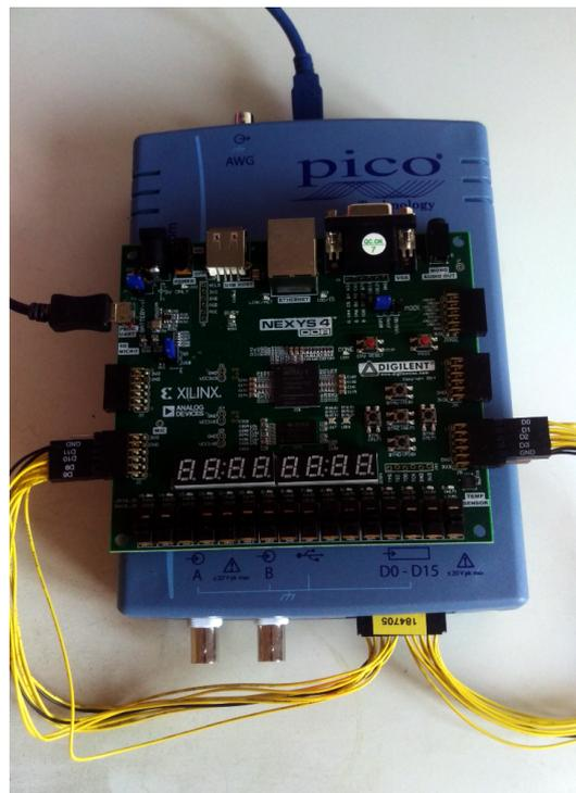
Abbildung 6.3: Die Darstellung des Messaufbaus mit dem USB-Oszilloskop PicoScope 2205 MSO.
