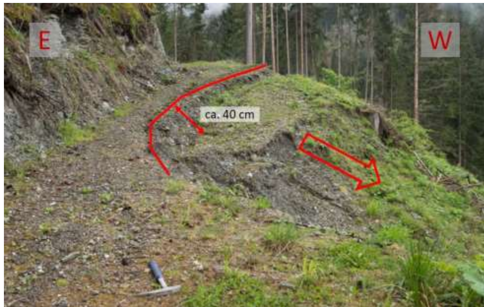
Abb. 4-32: Rotationsrutschung bei WP50
