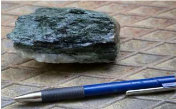
Abb. 4-10: Grünschiefer mit eingelagerter Quarzlage (weiß) im unteren Bereich
