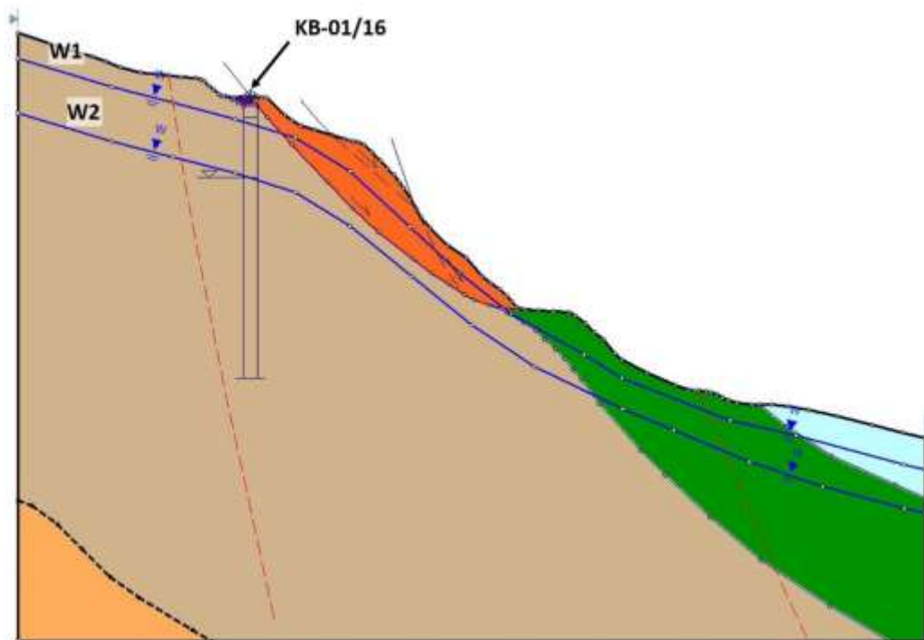
Abb. 7-2: Berechnungsmodell Profil A-A' mit den Wasserständen W1 und W2
