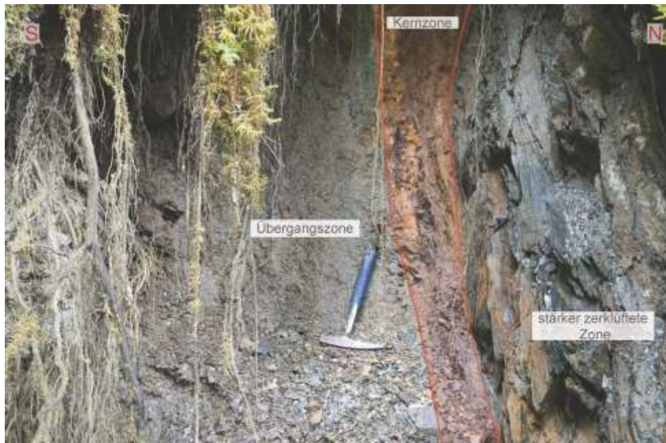
Abb. 4-19: tektonische Störungszone im Phyllit bei WP 58 mit Hauptbewegungsfläche rechts neben Kernzone
