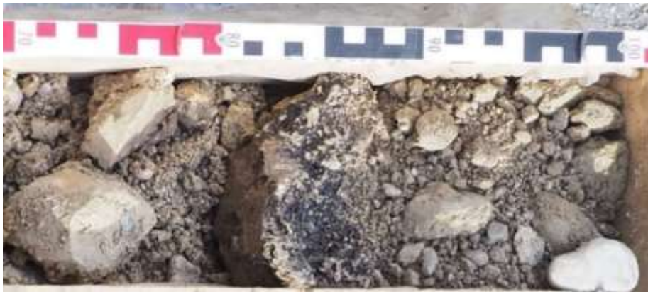
Abb. 4-2: Anthropogene Anschüttung mit Bruchstücken, Foto aus Bohrkernokumentation
