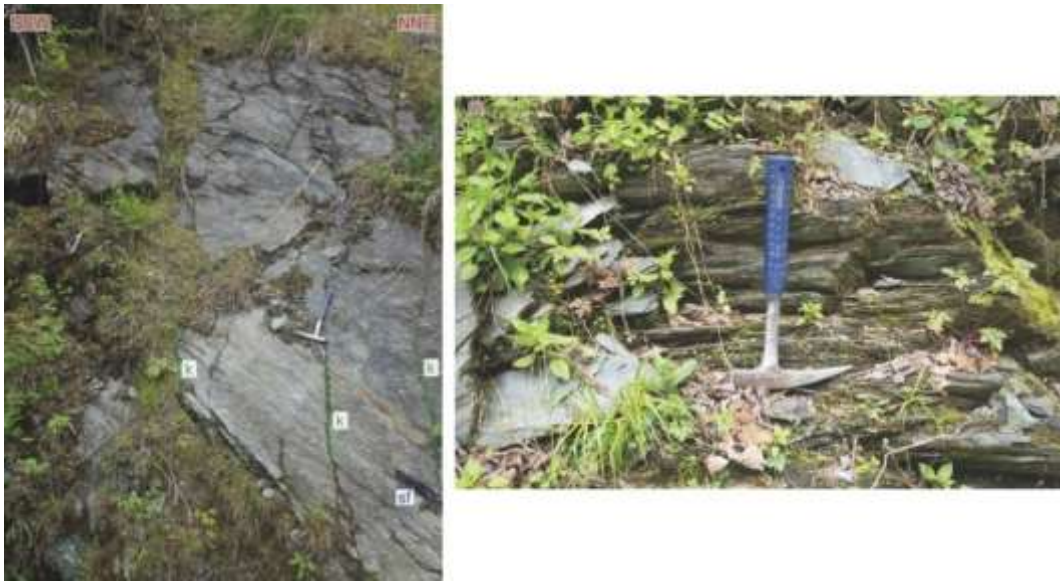
Abb. 4-12: Grünschieferaufschluss mit mäßig entfestigten (links: WP29) und stark entfestigten Bereichen (rechts: WP45)
