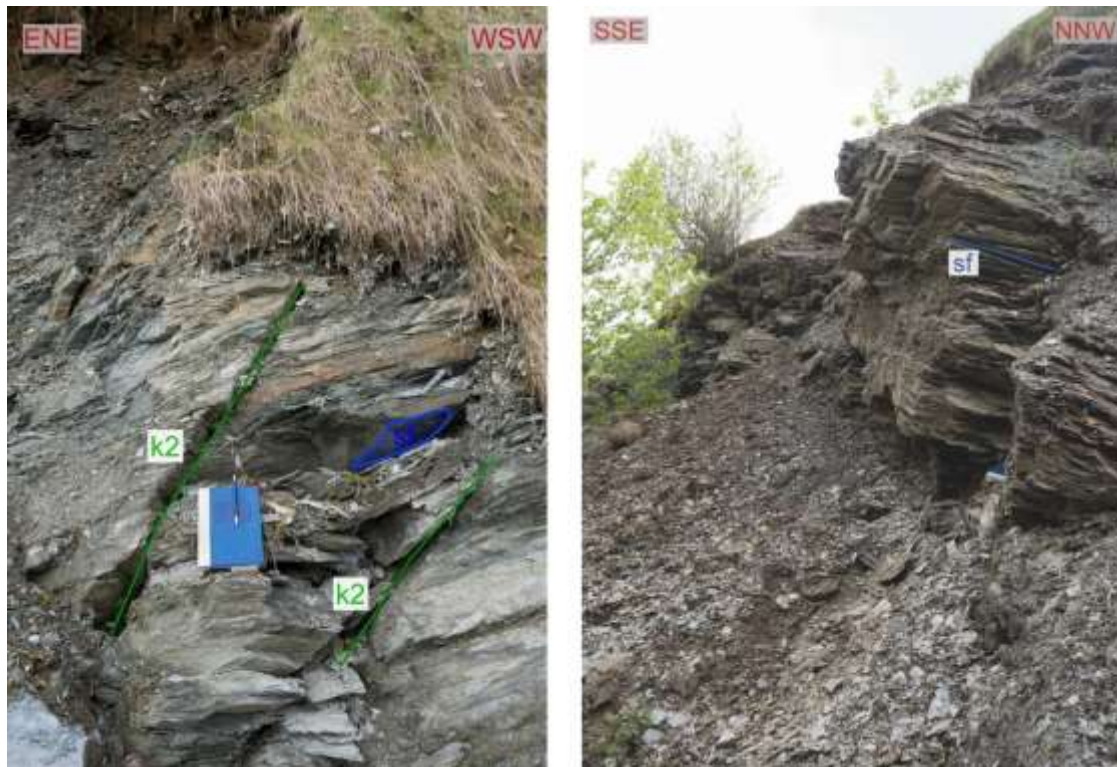
Abb. 4-7: Phyllitaufschluss mit mäßig entfestigten (links: WP10) und stark entfestigten Bereichen (rechts WP16)
