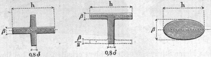
schnitt, welcher bei Anwendung der Räderformmaschine oder der Schablonen-Sandformerei am zweckmässigsten ist; der ovale Querschnitt erhält an allen Stellen die halbe Höhe zur Breite  $\beta$ . Man erzielt gute Verhältnisse für die Räder, wenn man die Anzahl  $\mathfrak{A}$  der Speichen nimmt:
