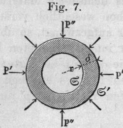
aussen, Fig. 7, ruft eine Beanspruchung der Rohrwand hervor, über welche Formel (27) Aufschluss zu geben vermag. Setzt man in derselben  $p = 0$  oder nimmt  $p$  als vernachlässigbar an, so erhält man:  $(\mathfrak{S} + 2p')\mu^2 = \mathfrak{S}$ , woraus:
