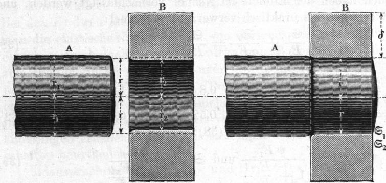
Aufzwängung eine gleichförmig vertheilte Druckspannung  $\mathfrak{S}_1$ , in *B* an der innersten Schicht eine solche auf Zug  $\mathfrak{S}_2$ . Für diese Spannungen gilt bei den Elastizitätsmodeln  $E_1$  und  $E_2$  gemäss Formel (2):
