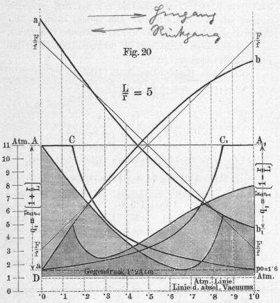
Die Gefahr des Unterschneidens liegt wegen der endlichen Pleuelstangenlänge nicht symmetrisch, sondern herrscht beim Gange des Kolbens gegen die Kurbelwelle zu am Beginne des Hubes und beim Rückgange etwas später als der Eintritt der Expansion. Von diesem Standpunkte aus wird selbst die Zulässigkeit von Ungleichheiten in der Steuerung zu beurtheilen sein, welche oft der endlichen Excenterstangen halber nicht völlig gleichartig sein kann.
