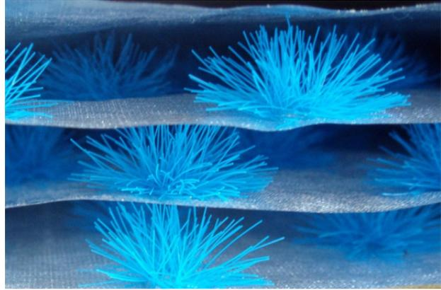
Abbildung 42 Schichtaufbau des aerofabrix[iso]
