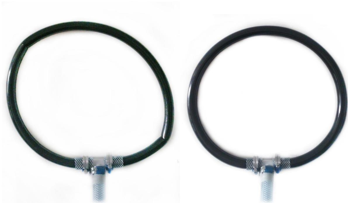
Abbildung 69 Polyamid-Folienschlauch unter Druck
