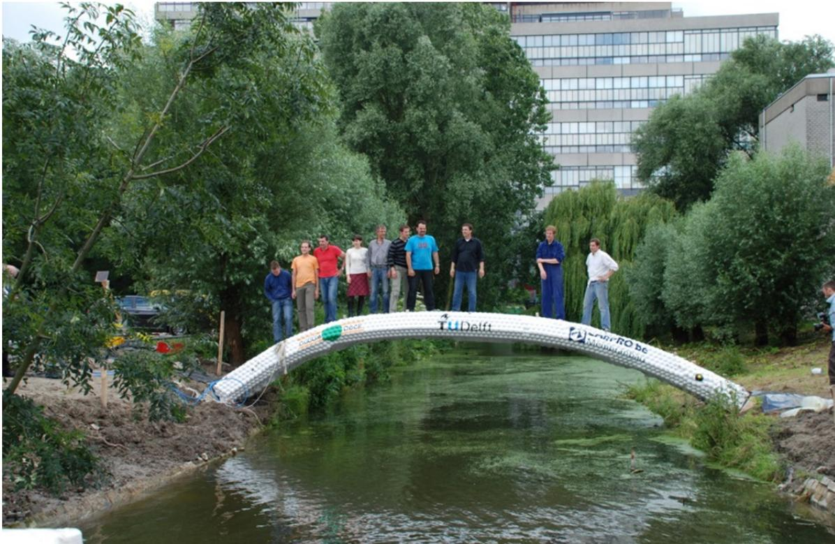
Abbildung 57 Vakuumbrücke unter Last
