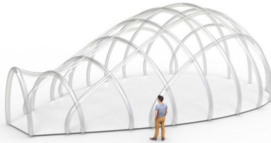
Abbildung 70 Modell mit halbierter Schlauchanzahl
