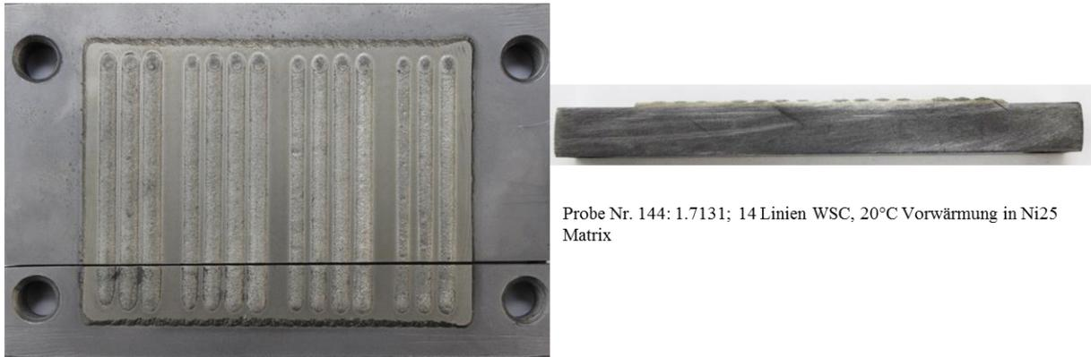
Probe Nr. 144: 1.7131; 14 Linien WSC, 20°C Vorwärmung in Ni25 Matrix
