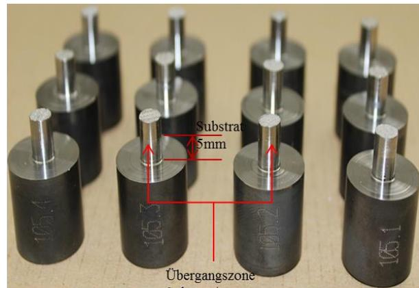
Fertig gedrehte Proben für die Scherfestigkeitsversuche
