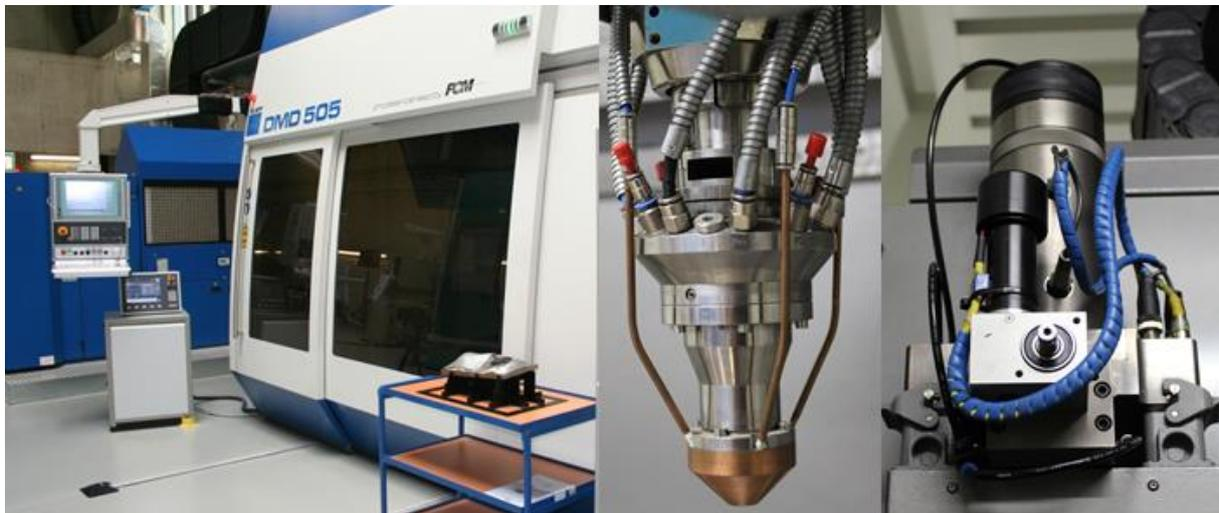
**Abbildung 8: Links: Laseranlage Trumpf DMD 505, 5-Achsen-CNC, 3200 Watt CO<sub>2</sub>-Laserzelle; Mitte: 4-Strahldüse; Rechts: hermetisch abgedichteter Pulverbehälter**
