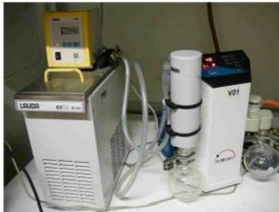
**Abbildung 16: Vakuumpumpe mit dazugehörigem Kryostaten (11)**
