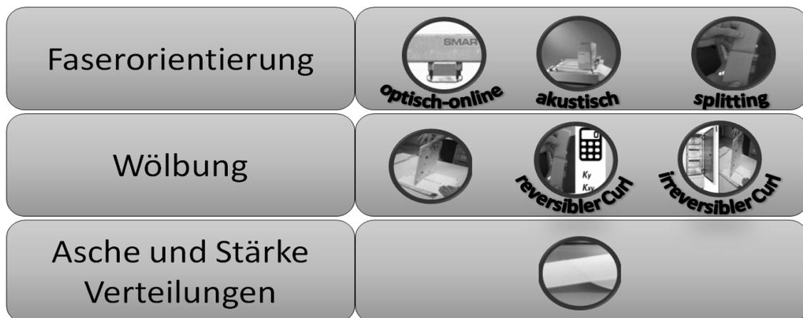
**Abbildung 20:** Darstellung der Messparameter (links) und den angewandten Messmethoden (rechts). Für die Bestimmung der Faserorientierung werden die Methoden optisch-online, akustisch und die Sheet-Splitting Methode durchgeführt. Die Wölbung wird visuell mit Vergleichskurven bewertet und die Asche und Stärkeverteilungen werden ebenfalls mit einer Splitting-Methode analysiert.
