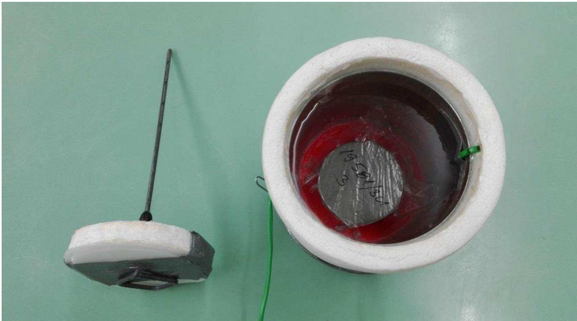
Abb. 48: Kalorimetrische Messung
