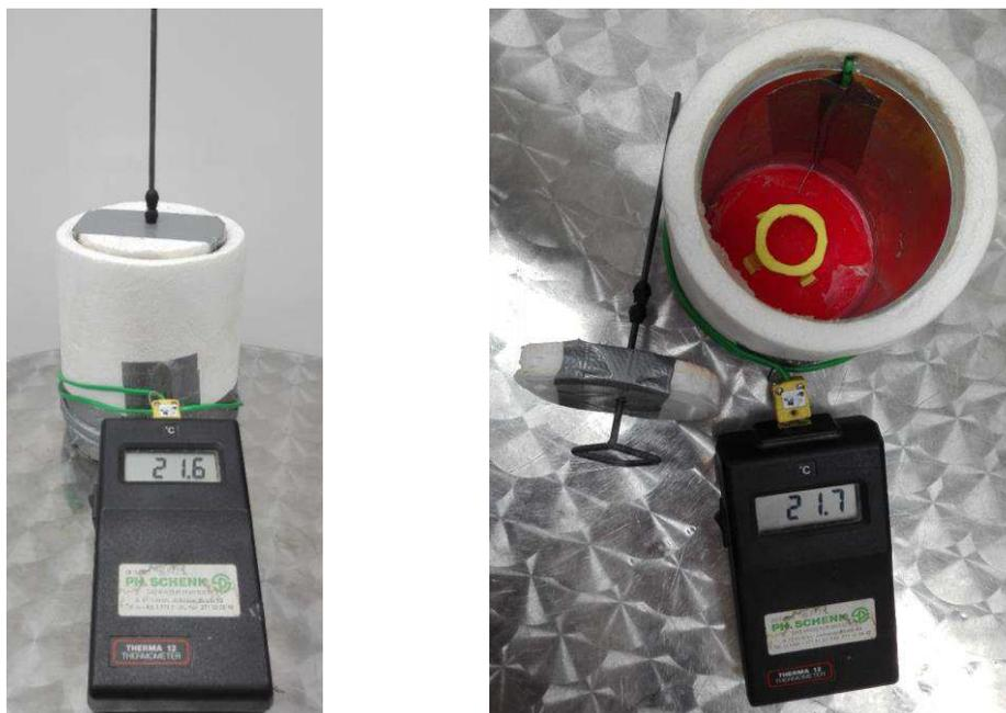
**Abb. 43:** Kalorimeter des Geotechnischen Labor des Instituts für Bodenmechanik und Grundbau an der TU Graz
