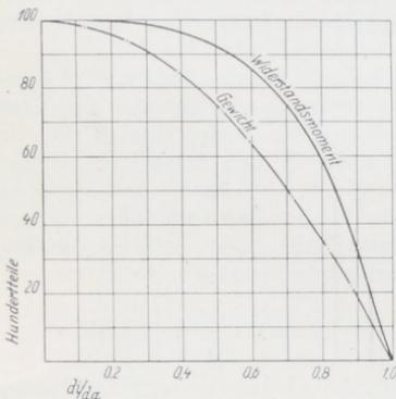
Abb. 1268. Wirkung des Ausbohrens von Wellen.
