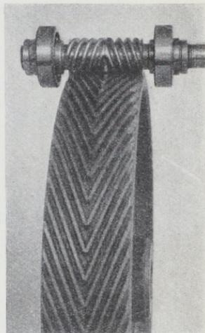
Abb. 1926. Pfeilradgetriebe der Zahnradfabrik Augsburg, vorm. Joh. Renk.
