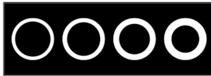
Abbildung 51: Kreisförmige Kontaktflächen ermöglichen den Einfluss der Wannenbreite  $W$  auf die Messungenauigkeit des Kontaktwiderstands zu verringern. Der innere Kreis und der äußere Bereich entsprechen den Kontaktflächen, die durch einen Ring der Breite  $d$  unterbrochen sind
