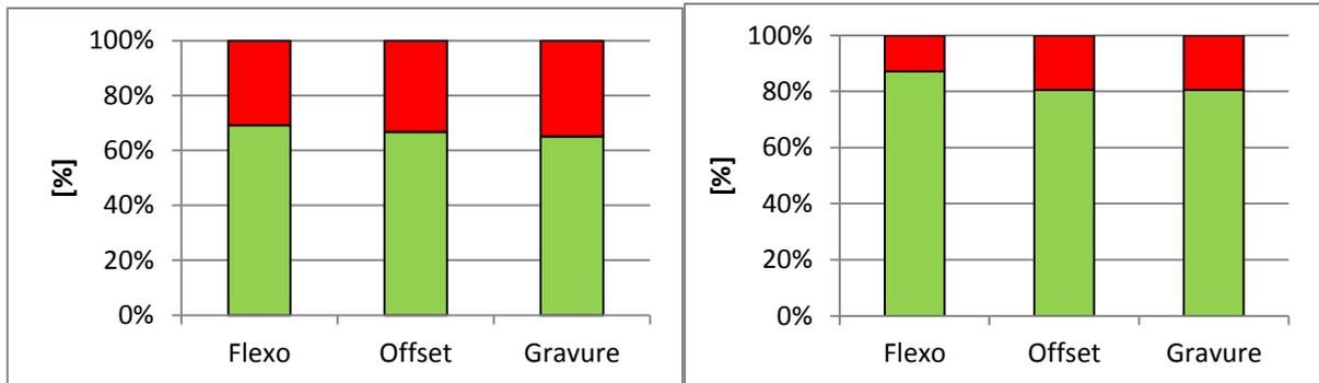
Abbildung 54: Vergleich des Kontaktanteils nach 100 ms      Abbildung 55: Vergleich des Kontaktanteils nach 1000ms
