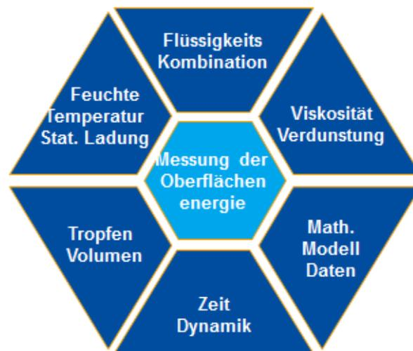
Abbildung 226: Einflussparameter auf die Benetzbarkeit der Oberfläche
