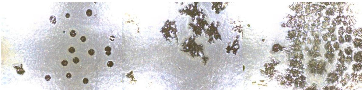
Abbildung173: Störungsbilder durch Wechselwirkungen 140-fach (DPM)
