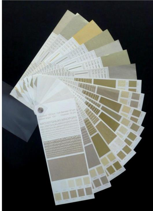
Abbildung 2923: Musterfächer verschiedener Papiere mit Effektfarbe gedruckt auf MAN Roland 300; Flexodruck und Rotogravure 150 m/min
