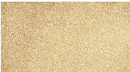
Abbildung 124: Missing dots der gedruckten Oberfläche 20fach vergrößert
