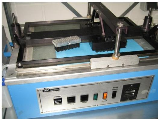
Abbildung 200: BYK Scheuertester PB 5005
