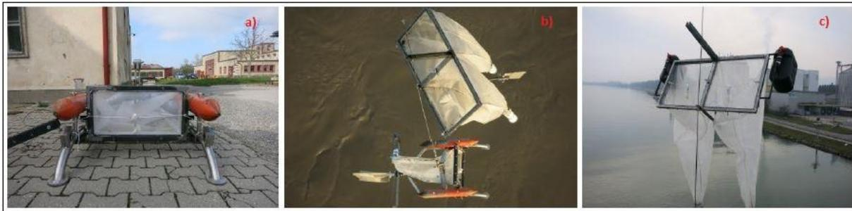
Abbildung 4-2: Verwendete Fangnetze für die 3 unterschiedlichen Tiefen a) sohlnah, b) mittig und c) oberflächennah (Hohenblum et al., 2015, modifiziert)
