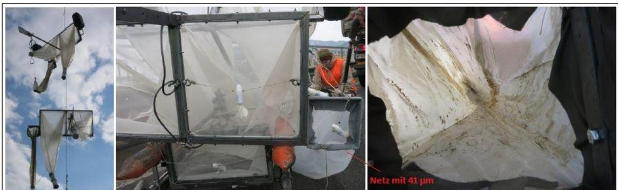
Abbildung 4-3: Lage und Aufbau des 41  $\mu\text{m}$  Netzes am Rahmen (Hohenblum et al., 2015, modifiziert)
