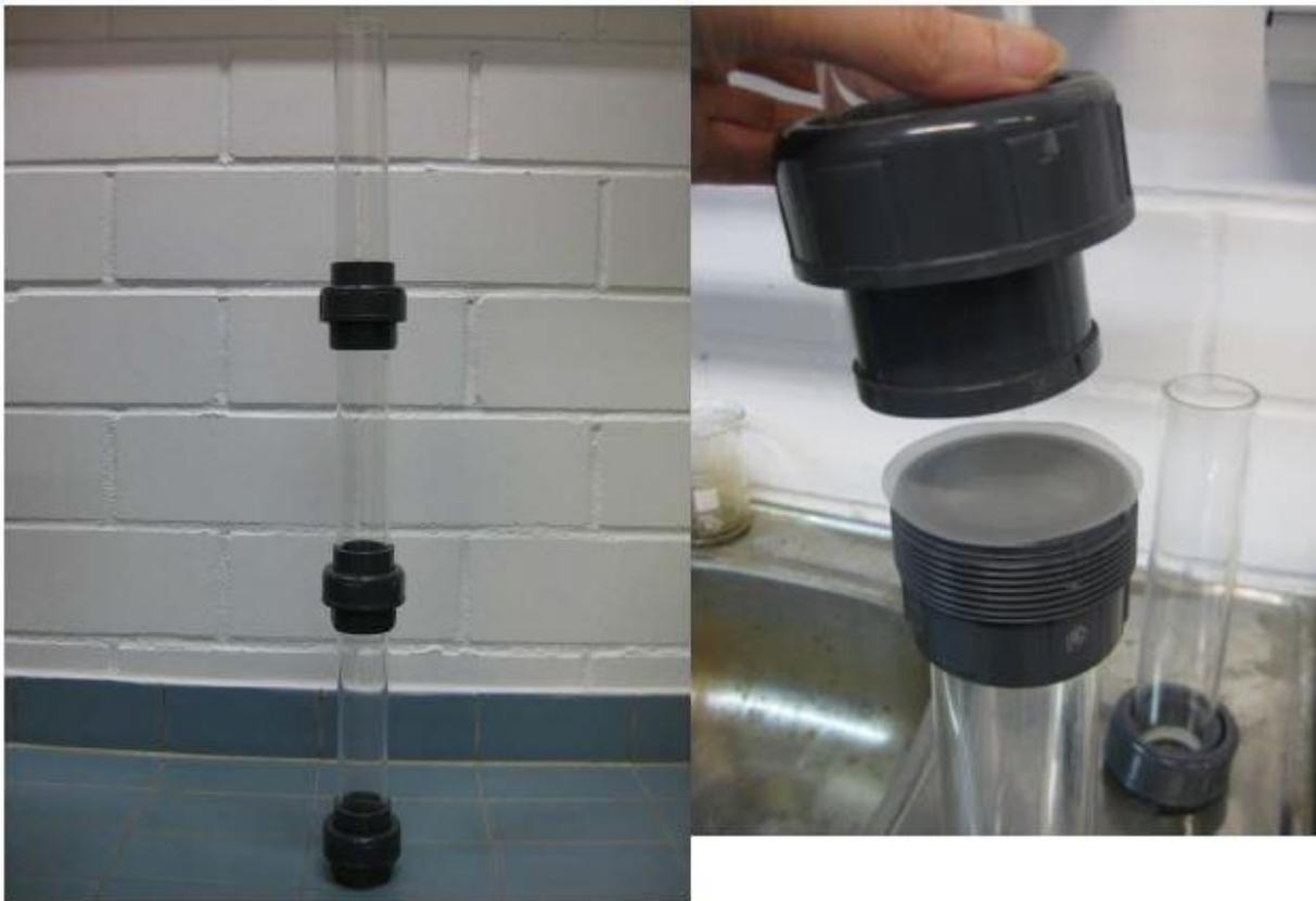
Abbildung 4-22: Aufbau der Messeinrichtung für die Beprobung der Abwasserreinigungsanlage in St. Petersburg (Talvatie & Heinonen, 2014)
