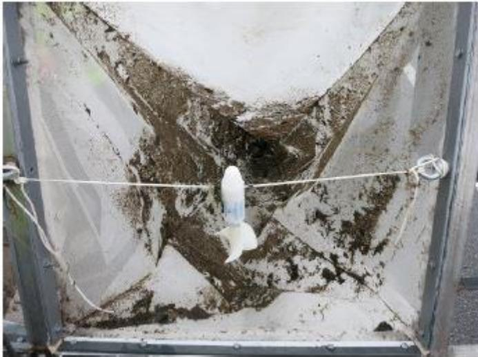
Abbildung 4-4: Lage des hydrometrischen Flügels am Netzrahmen (Hohenblum et al., 2015)
