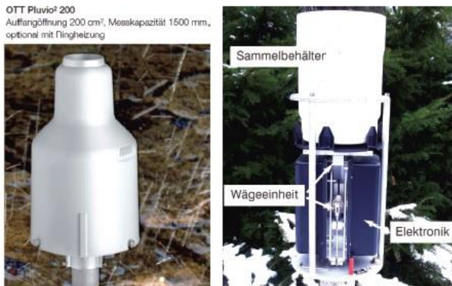
Abbildung 2-11: Niederschlagsschreiber mit Wiegenprinzip (Ott Hydrometrie, Foto rechts: Wupperverband) (Fürst, 2012)
