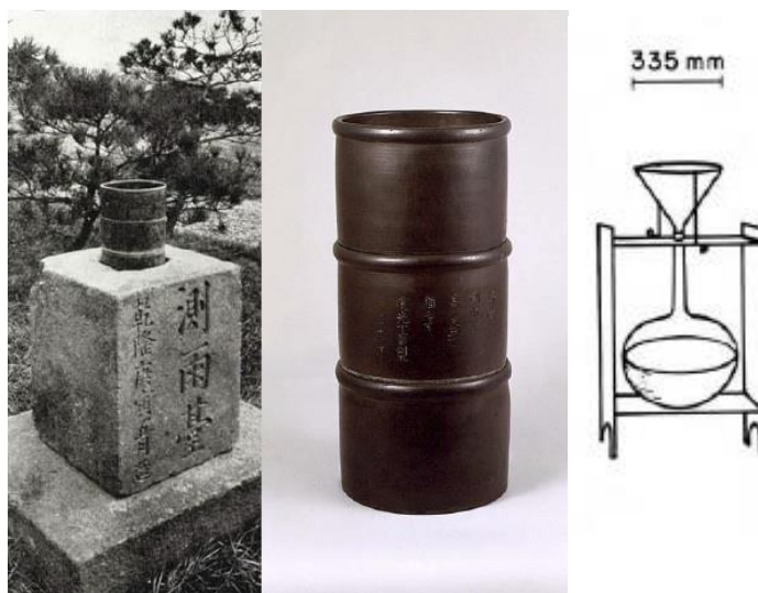
Abbildung 2-6: Links: Koreanischer Niederschlagsmesser aus 1770 n. Ch. (Sevruk, 1981), Rechts: Niederschlagsmesser nach Hooke ( www.slideplayer.org , letzter Zugriff am: 24.08.2016)
