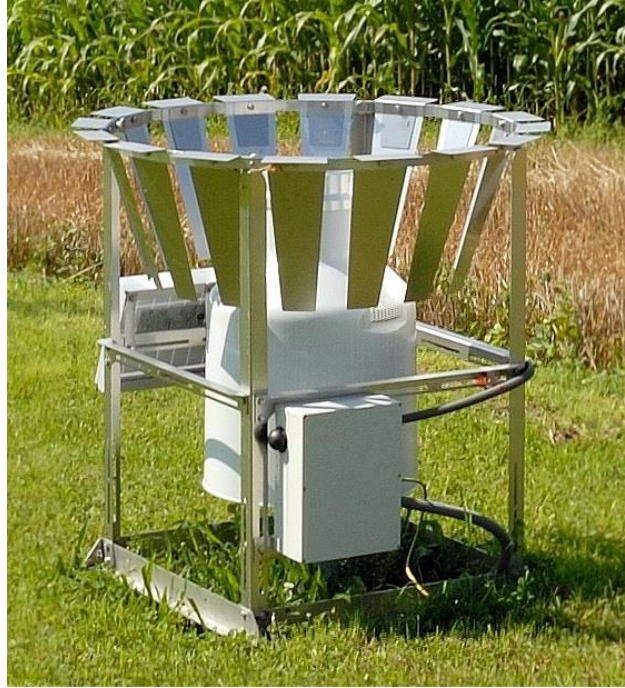
Abbildung 2-15: Windring bei einer Niederschlags-Messtation ( https://de.wikipedia.org/wiki/Niederschlagsmesser , letzter Zugriff am: 19.09.2016)
