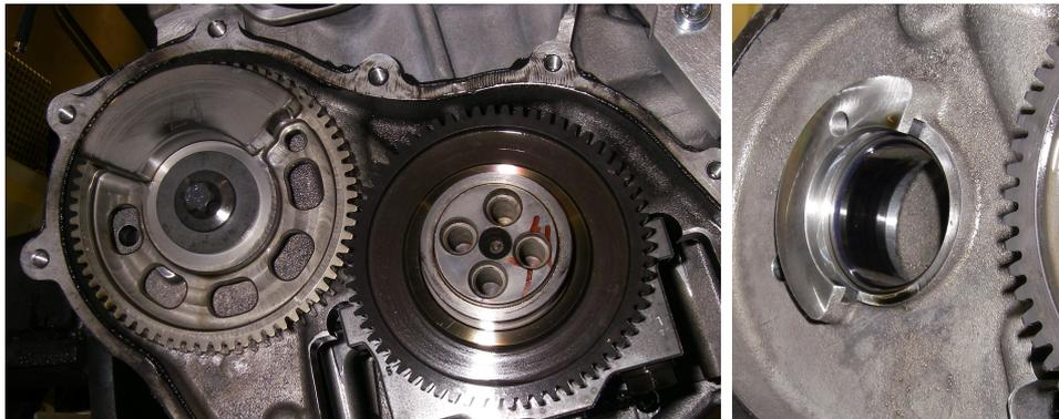
Bild 6.28: Links: Antrieb der AGW, Rechts: Axiallager der AGW
