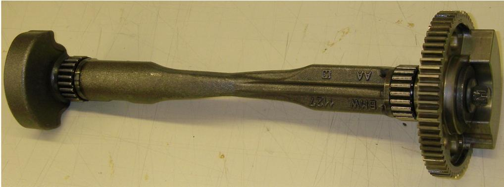
Bild 6.29: Ausgleichswelle mit Lagerstellen
