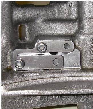
Bild 6.21: Flatterventile der Vakuumpumpe
