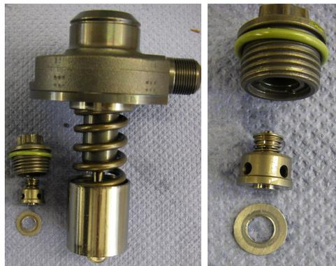
Bild 6.15: Pumpenelement der Hochdruckpumpe Bosch CP4
