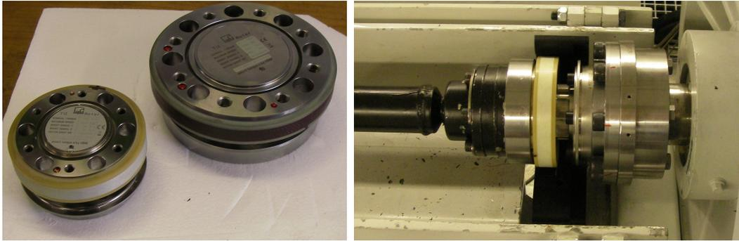
Bild A.2: Drehmomentmessflansch HBM T12
