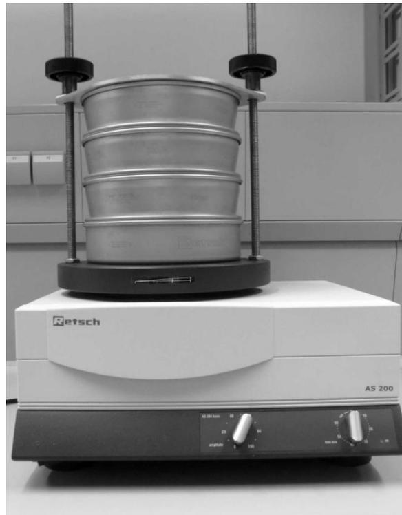
Abb. 3-4: Analysensiebmaschine AS 200 basic
