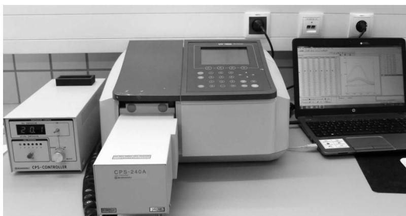
Abb. 3-6: Shimadzu UV-1800 Photospektrometer
