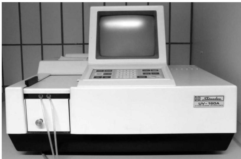
Abb. 3-5: UV/Vis-Photospektrometer Shimadzu UV-160A
