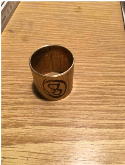
Abb. 23 Ausstechzylinder ( $V = 14,5475 \text{ cm}^3$ )
