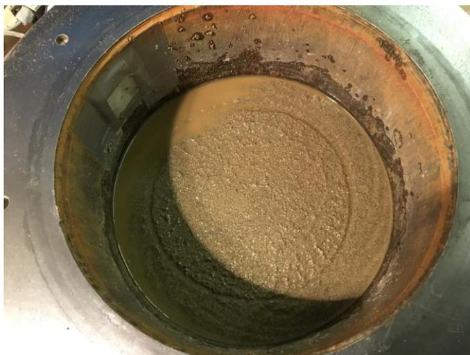
Abb. 21 Wasserfilm auf der Oberfläche nach dem Verdichten der letzten Sandschicht
