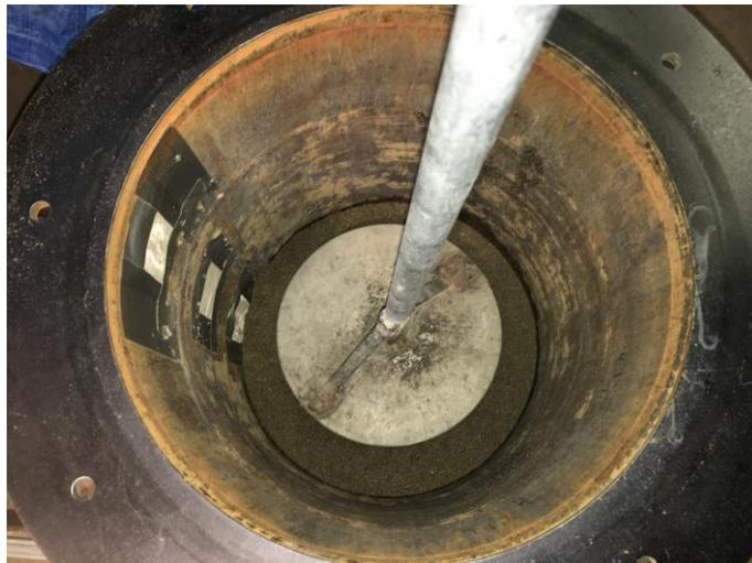
Abb. 20 Einbau des Sands in den Zylinder
