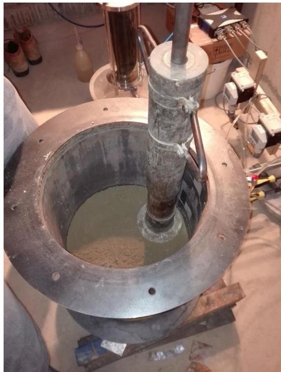
Abb. 19 Einbau des Schluffs in den Zylinder
