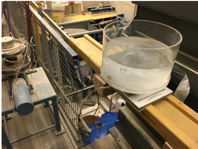
Abb. 22 Wasserbehälter oberhalb des Versuchszylinders (Wasserspeicher für die Sättigung, ständige Kontrolle der Masse über die Waage)
