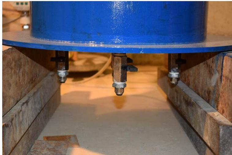
Abb. 7 Grundauslässe für die Sättigungsphase
