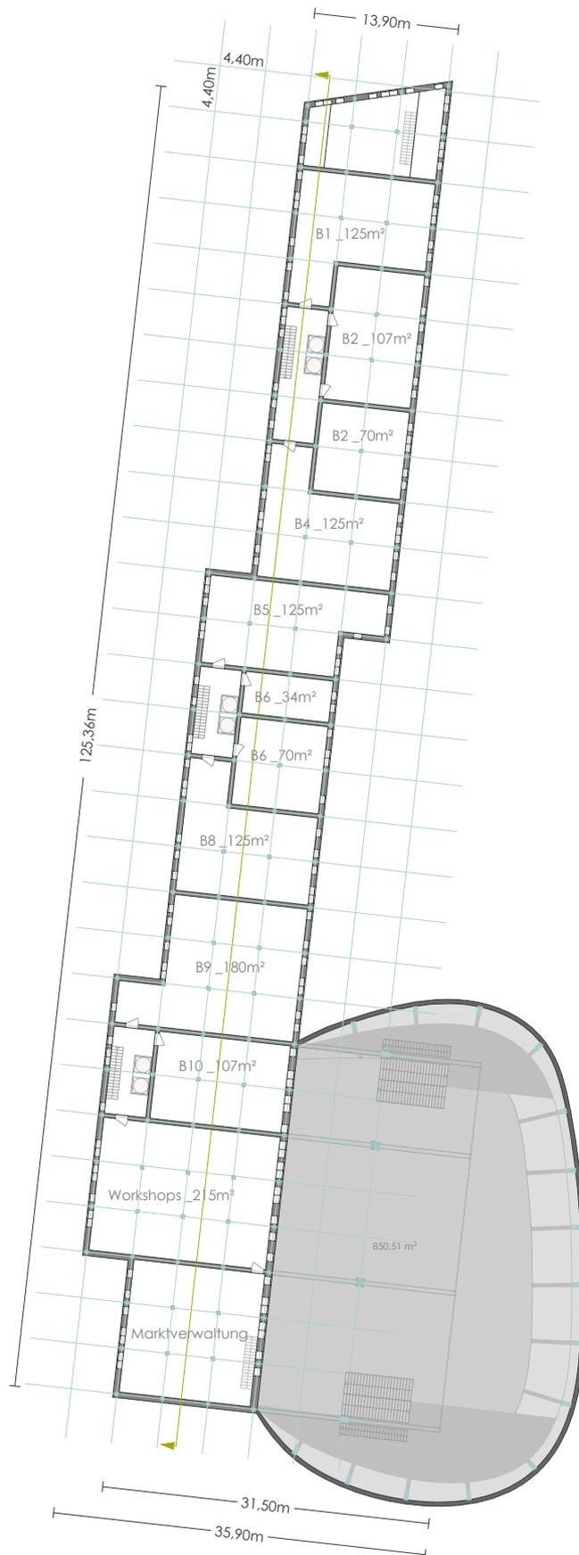
Im zweiten Obergeschoss befinden sich überwiegend Gewerbeflächen. Durch das Stützenraster von 4,40x4,40m ergeben sich Raumgrößen zwischen 54m<sup>2</sup>-180m<sup>2</sup>. Erschlossen werden diese über die Eingänge an der Westseite des Gebäudes. Alle Bereiche sind barrierefrei durch Aufzüge zu erreichen.
