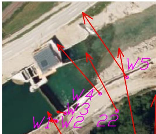
Abb. 31 Messpunkte W1 – W5 mit Verschiebungsvektoren bis Mai 2015
