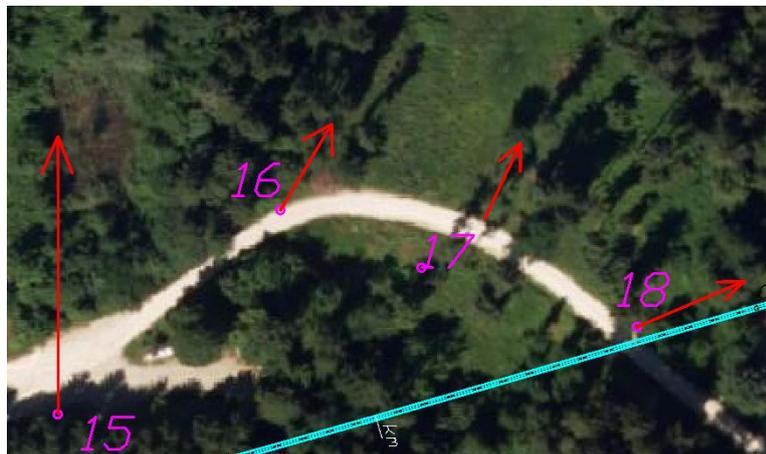
Abb. 35 Messpunkte 16 – 18 mit Verschiebungsvektoren bis Mai 2015
