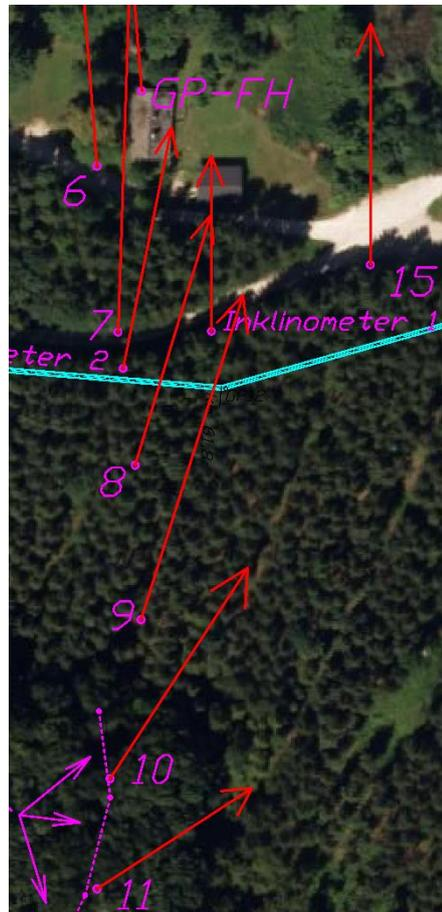
Abb. 39 Messpunktgruppe Oben mit Verschiebungsvektoren bis Mai 2015
