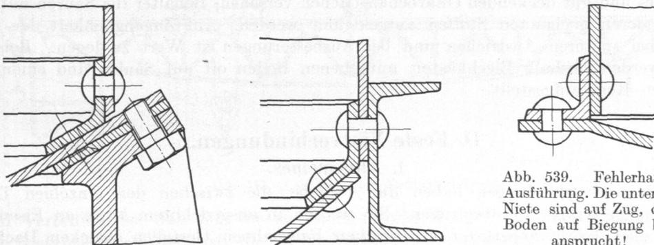
Abb. 537 und 538. Bodenanschlüsse.
