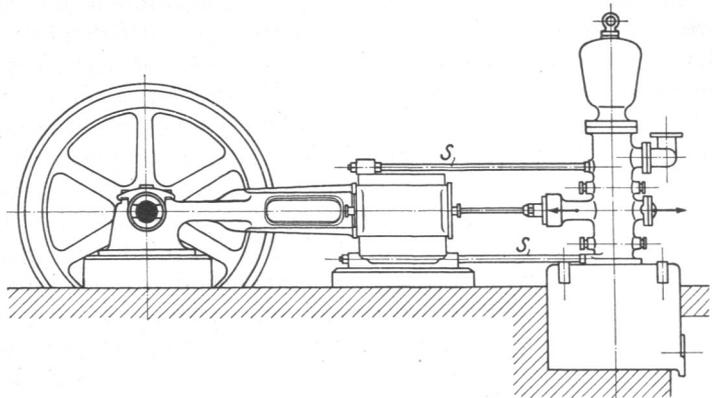
Abb. 151. Unmittelbare Übertragung der Kräfte zwischen Pumpe und Rahmen durch die Stangen *S* (nach Riedler).
