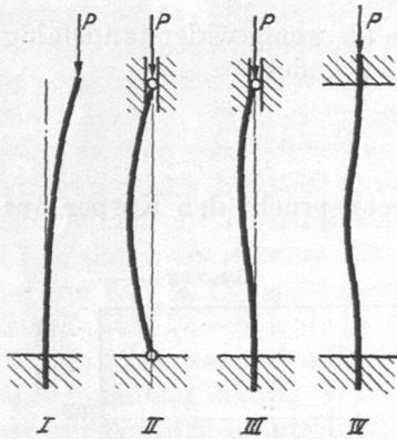
Abb. 16–19. Die vier Eulerschen Fälle der Inanspruchnahme auf Knickung.
