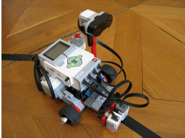
*Abbildung 10: Standard Roboter mit differential Antrieb und einigen Sensoren*
