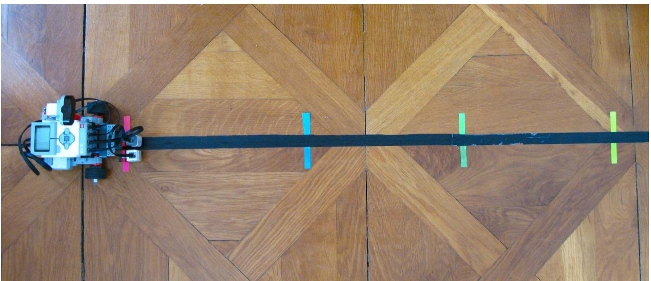
*Abbildung 17: Realisierung der Teststrecke eines Lego-Mindstorms-Ev3 als Paketlieferroboters*
