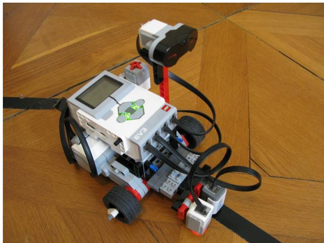
*Abbildung 1: Der Lego-Mindstorms-Ev3 als Linienfolger*
