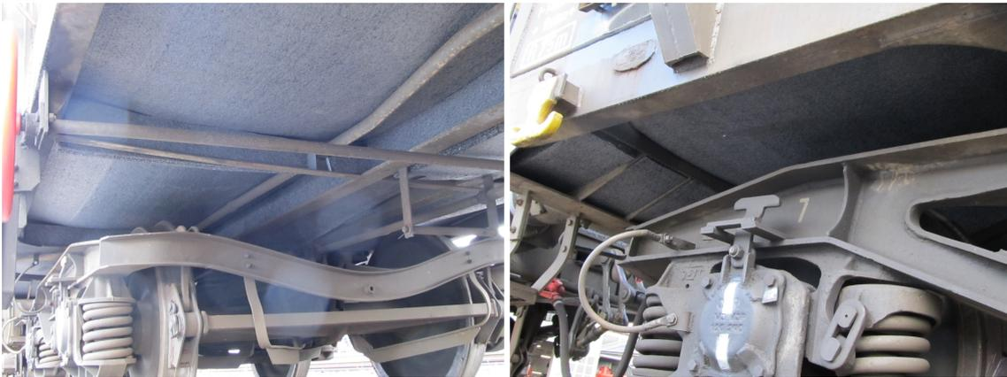
Abbildung 3.34: Absorptionsmaterial am Unterboden des Eaos-Güterwagens
