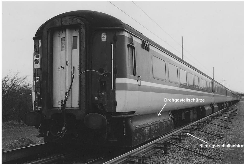
Abbildung 3.9: Drehgestellschürzen und Niedrigschallschirme am Test-Zug der British Rail, modifiziert aus [JHJW96]
