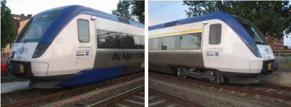
Abbildung 3.13: Regina 250 Test-Zug mit und ohne Drehgestellschürze [CF11]
