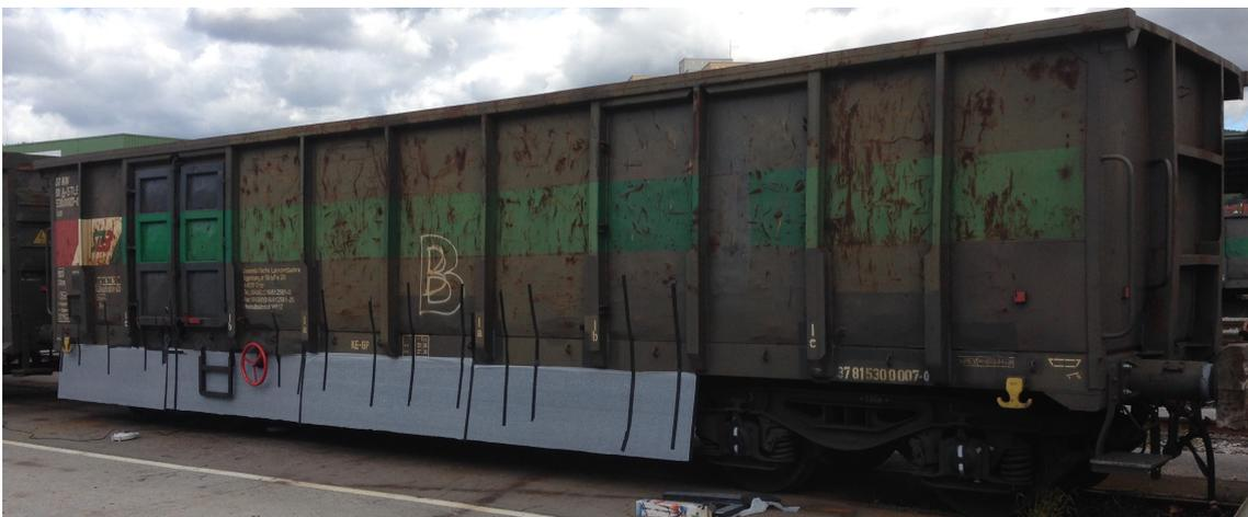
Abbildung 3.35: Am Güterwagen seitlich angebrachtes Absorptionsmaterial
