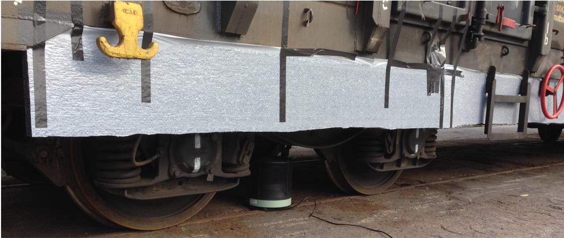
Abbildung 3.36: Halbierte Schürzen und Normschallquelle in Position 1
