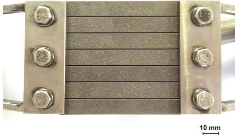
Abbildung 5-5: Probenhalter mit eingelegten Probenstreifen
