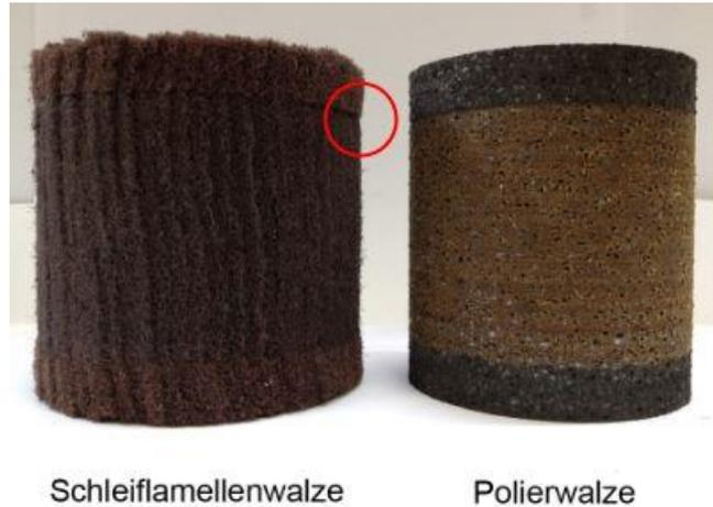
Abbildung 4-7: Schleiflamellenwalze aus Schleifvlies und Polierwalze mit Verschleiß
