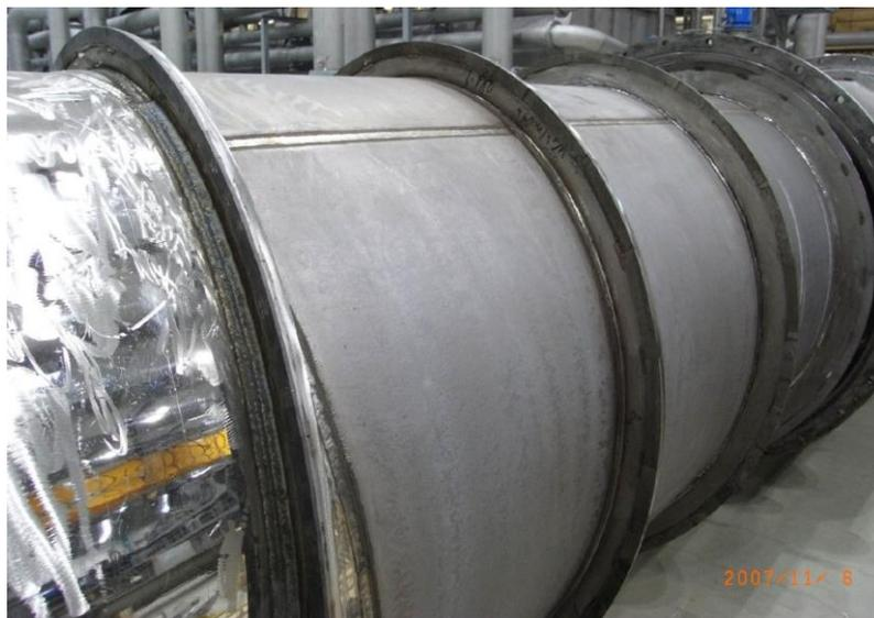
Abbildung 1-1: Schneckenwelle mit aufgebrauchten Beschichtungsblechen
