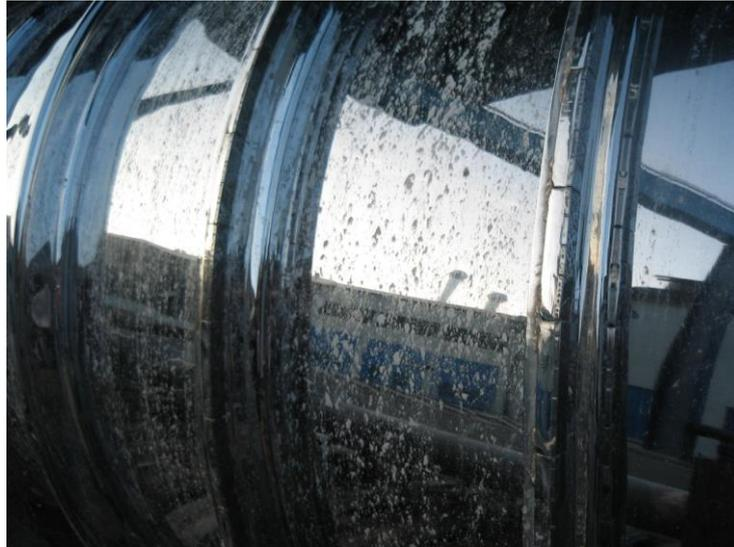
Abbildung 4-5: Aufpolierter Grundkörper einer Schneckenwelle
