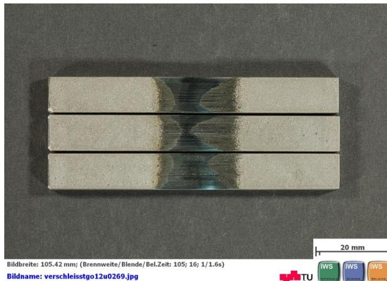
Abbildung 5-6: Erhöhter Verschleiß an den Außenkanten der Außenproben
