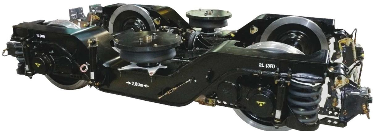
Abbildung 2: Drehgestell (Siemens)
