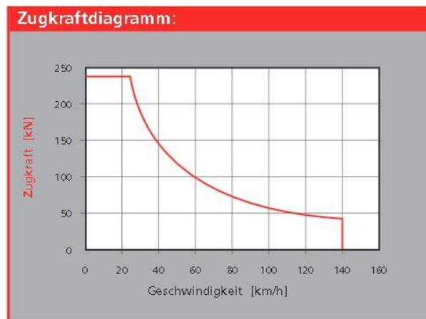
Abbildung 62: Zugkraftdiagramm 2016 Hercules[15]
