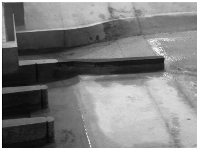
Abbildung 1.3: Trennpfeiler-Verlängerung ohne Abtreppung
