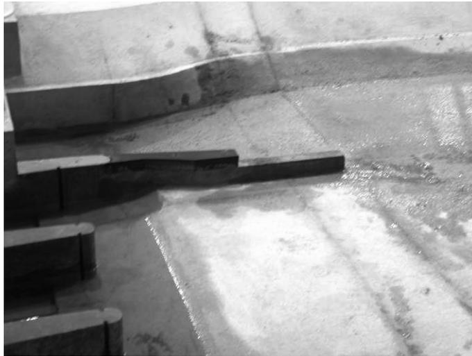
*Abbildung 1.4: Abgestufte Trennpfeiler-Verlängerung*
