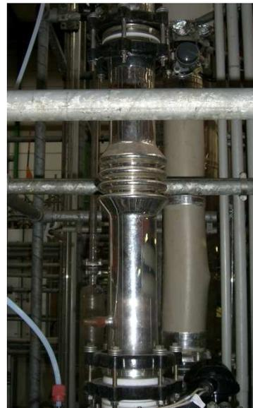
Abbildung 3-2: Kolonnenschuss mit Dehnungsbalg
