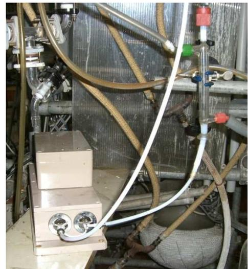
Abbildung 3-10: Dichtemesszelle 1 im Sumpf
