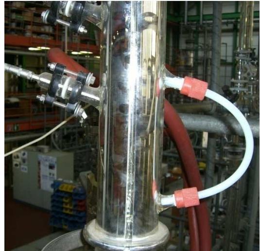
Abbildung 3-3: Teflonbypass mit Temperaturmessstelle
