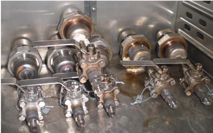
Abbildung 3-16: Liegende Probenbehälter im Trockenofen nach Ablauf der Versuchsdauer
