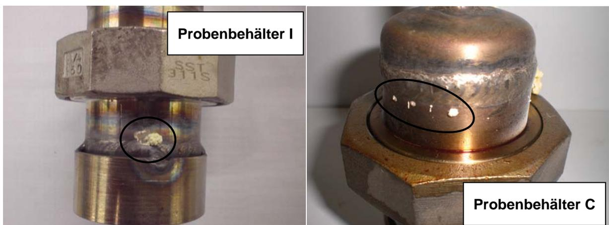
Abbildung 3-17: li.: Probenbehälter I mit Korrosionsangriff Schweißnaht unten, re.: Probenbehälter C mit kleinen Punkten Schweißnaht oben
