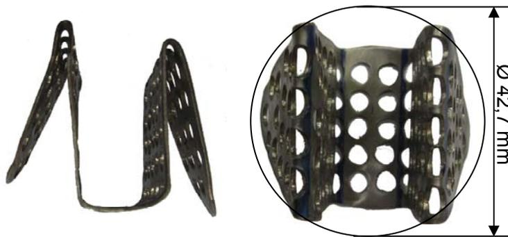
Abbildung 4-10: Siebboden der Rektifikationskolonne
