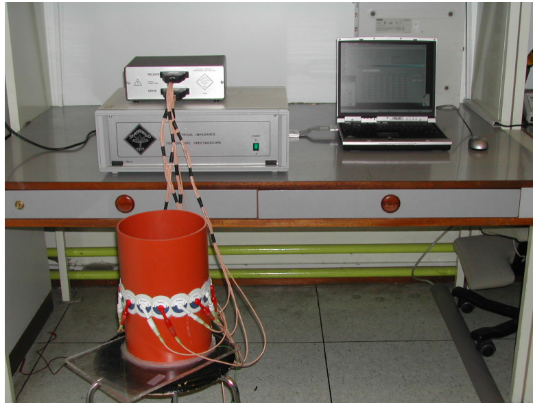
Abbildung 1.13.: Laborplatz mit dem MK3a EIT-Spektroskop mit einem Salzwanne als Messobjekt. Gesteuert wird der MK3a mit der Interfacesoftware auf einem Notebook.
