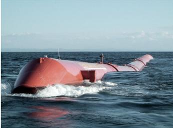
Der „Pelamis - wave energy converter“ in der Testphase. Wellenenergie wird mechanisch aufgefangen und in Strom umgewandelt.
