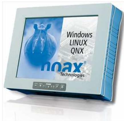
Abb. 7: Staplerterminal<sup>28</sup>
