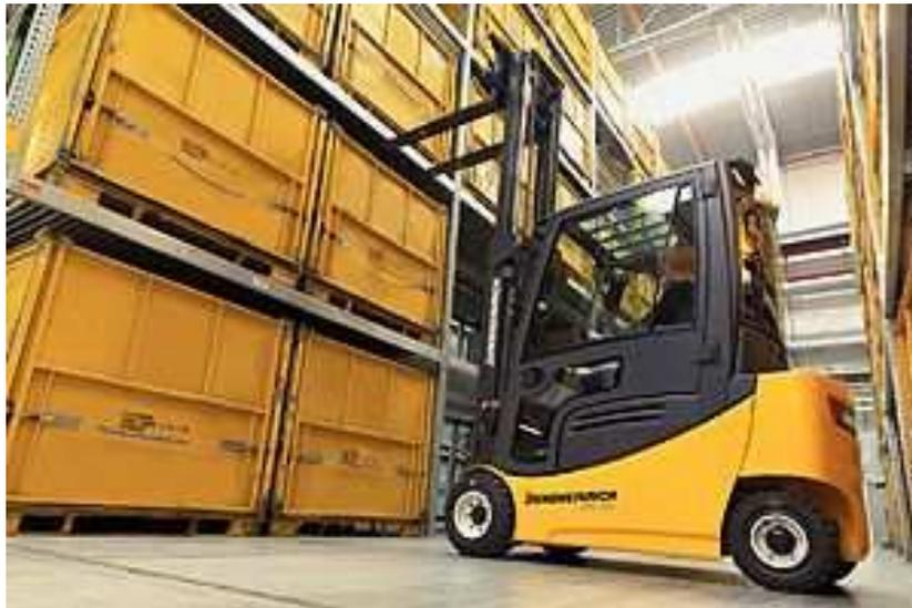
**Abb. 2:** Frontgabelstapler bei der Regal Be-/Entladung <sup>17</sup>
