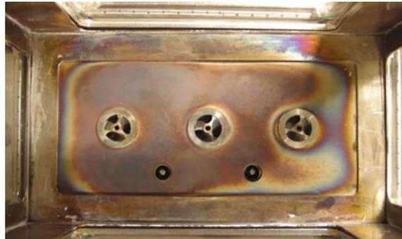
Abbildung 23 Links: Drallerzeuger (Köberl), Rechts: Einbau der Drallbrenner in die Brennkammer, Ansicht aus der Modellbrennkammer
