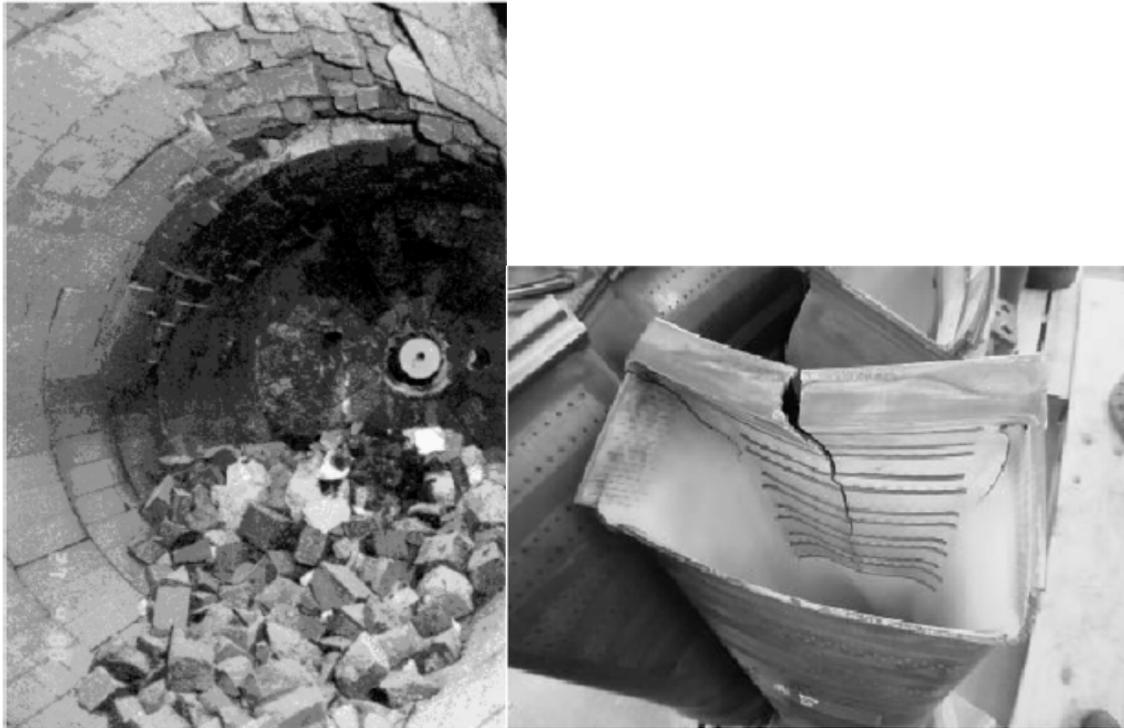
Abbildung 6 Links: Zerstörte Ausmauerung eines Winderhitzers durch Druckpulsation. Rechts: Schaden in einem Übergangsstück durch Brennkammerpulsationen (Joos 2006)
