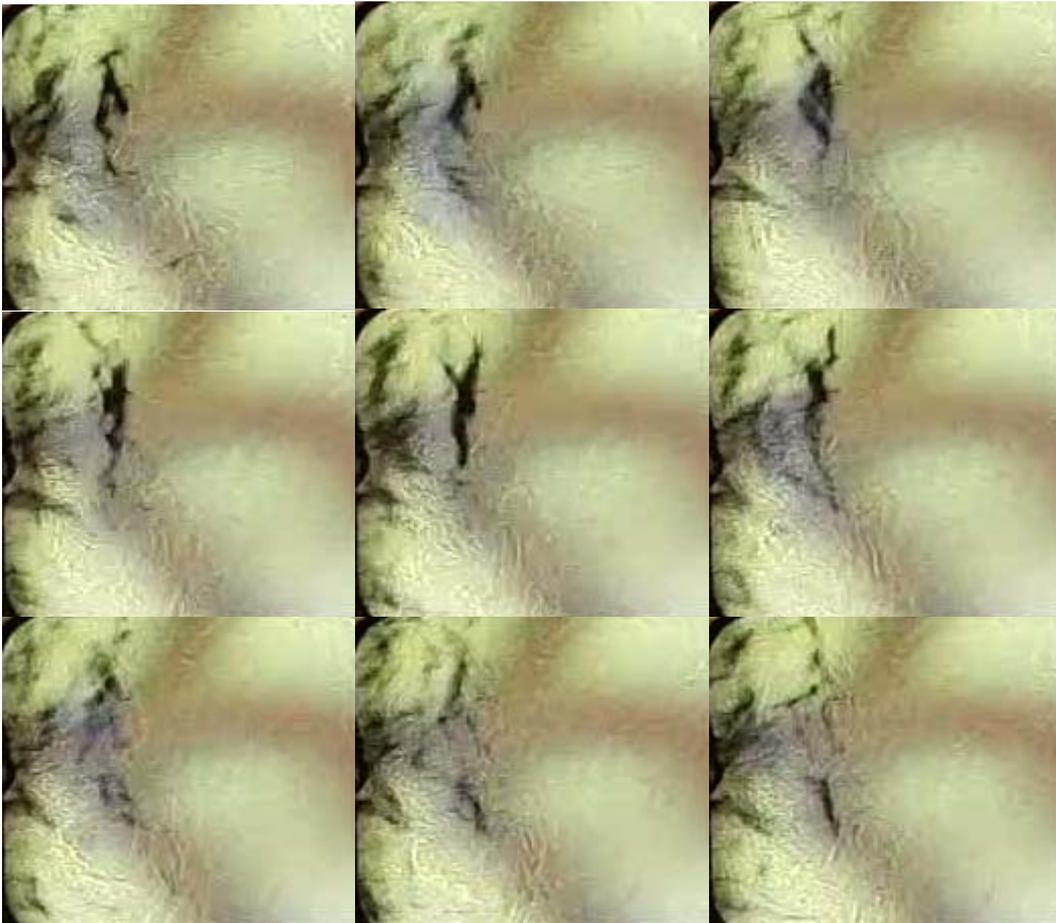
Abbildung 44 Pulsierende Flamme bei 135,9 Hz. Aufnahmefrequenz 600 fps
