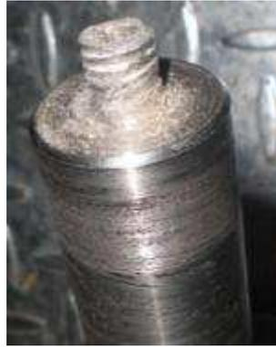
**Abbildung 4-12 zerstörte Gewindeverbindung**
