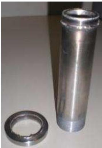
**Abbildung 4-20 zerstörte Presshülse**
