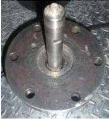
**Abbildung 4-11 verdrückte Schneidvorrichtung**
