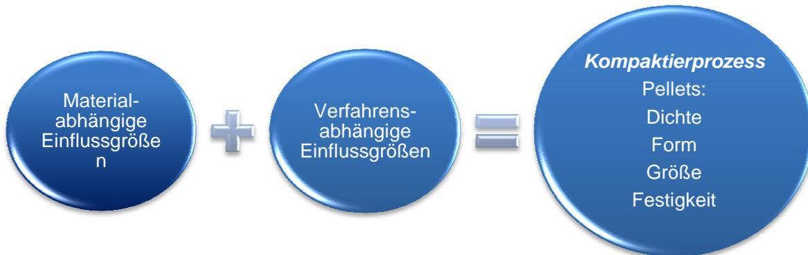
**Abbildung 3-22 Einflussgrößen auf den Kompaktierprozess**
