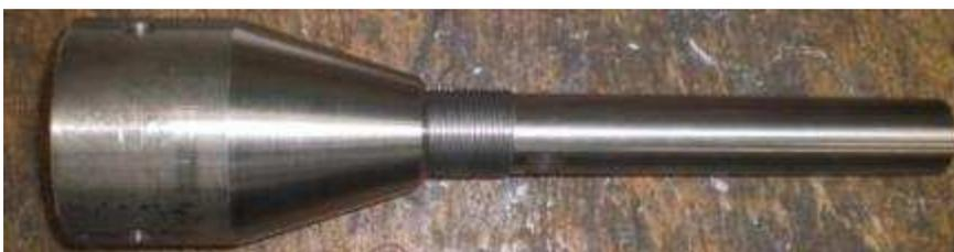
**Abbildung 4-15 neue Schneidvorrichtungsbefestigung**
