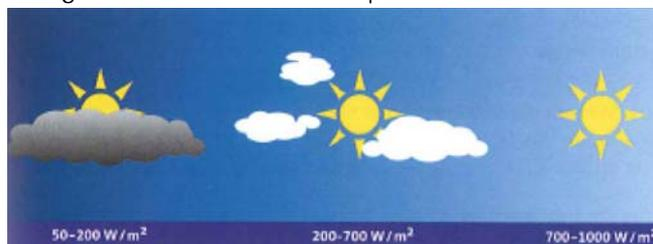
Abb.3.4: Sonneneinstrahlung bei unterschiedlichem Wetter © Solarpraxis AG (vgl. [59] S. 17)
