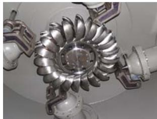
Abb. 2.9: Peltonturbine Abbildung: eurosolar.at/Kleinwasserkraft Österreich [23]
