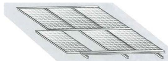
Abb.3.27: Modulhalterung auf Kreuzschienen
