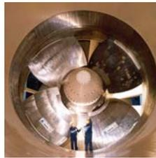
Abb. 2.8: Kaplan-Turbine Abbildung: © Verbund [63]
