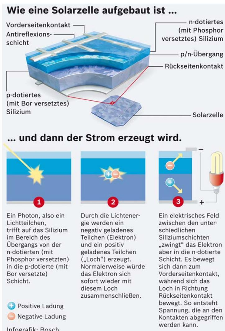
Abb.3.8: Funktionsweise einer Solarzelle Quelle: Bosch vgl.: [3]
