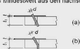
Abb.6.11: einschnittige Stahl-Holz-Verbindung [35]
