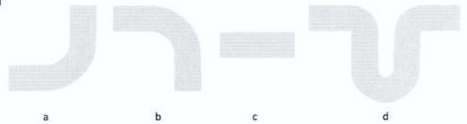
Abbildung 2 Anschlussarten; a) nach oben, b) nach unten, c) gerade, d) Siphon
