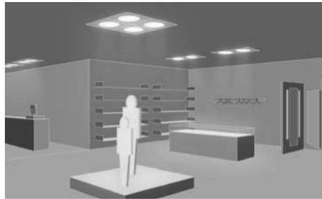
Abb. 036 Dreh-/schwenkbare Einbauleuchten
