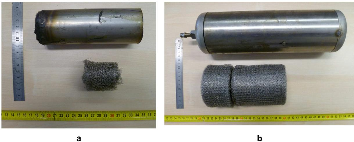
Abbildung 3-12: a.) Tropfenabscheider vor Umbau; b.) Tropfenabscheider nach Umbau
