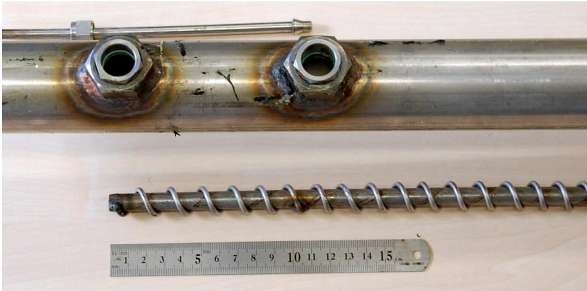
Abbildung 3-4: Verdampfer nach Umbau - oben: Außenrohr mit Schaugläser, unten: Wendel Kaltwasser
