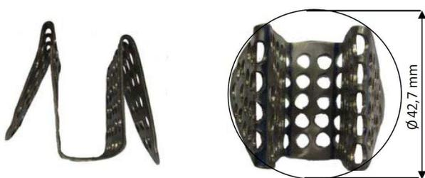
Abbildung 3-11: Siebboden der Füllkörperkolonne (Rieberer et al., 2010)
