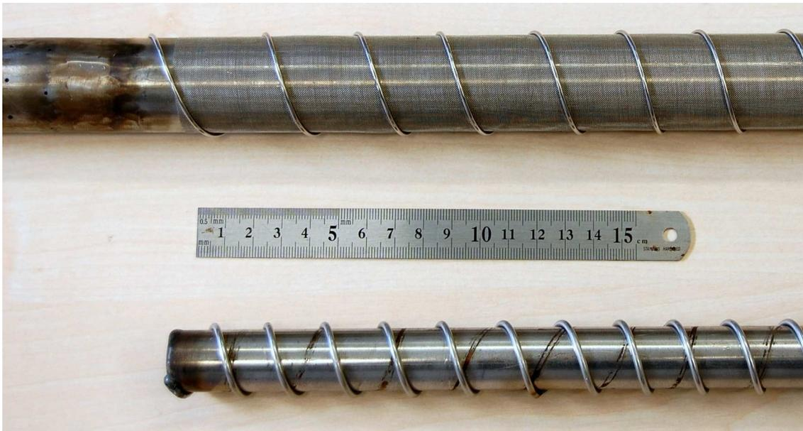
Abbildung 3-7: Absorber nach Umbau - oben: Gitternetz und Wendel Fallfilm, unten: Wendel Kühlwasser
