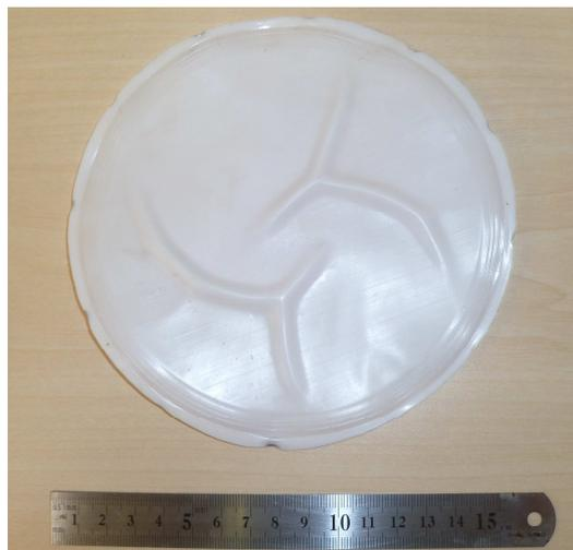
Abbildung 3-16: Faltenwurf der Teflonmembran
