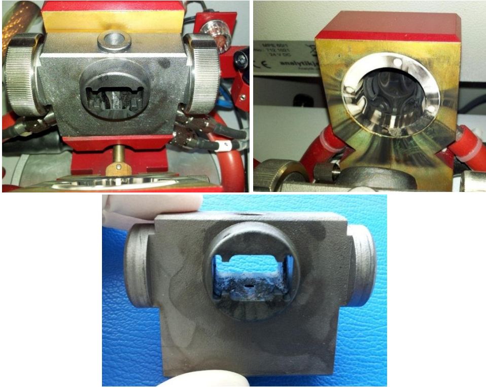
Abbildung 76: Verschmutzungsgrad nach ca. 400 Heizzyklen.
