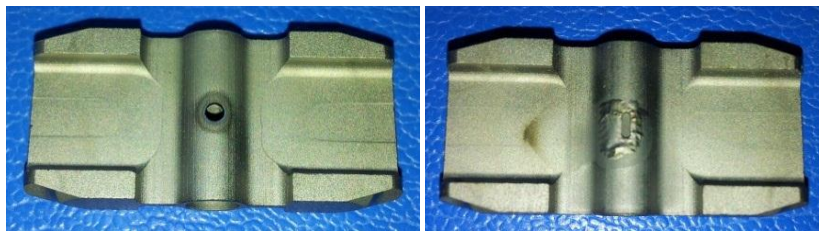
Abbildung 69: Extrem schnell alterndes Graphitrohr mit nur 30 Heizzyklen.
