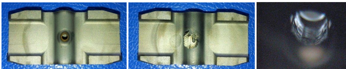
Abbildung 70: Graphitrohr mit exzessiven „Abschälverhalten“ mit 129 Heizzyklen.
