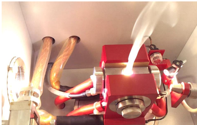
Abbildung 35: Extreme Rauchbildung beim Ausheizen durch ein ungeeignetes Ofenprogramm.
