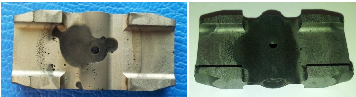
Abbildung 60: Große, unsymmetrische eingebannter Flecken auf der Oberseite der Graphitrohre.
