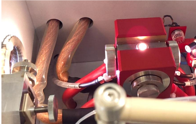
Abbildung 36: kaum sichtbare Rauchbildung beim Atomisieren durch ein geeignetes Ofenprogramm.
