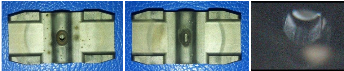
Abbildung 68: normal alterndes Graphitrohr mit 175 Heizzyklen.
