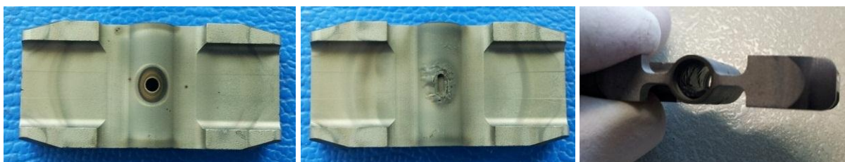
Abbildung 66: langsam alterndes Graphitrohr mit 175 Heizzyklen.
