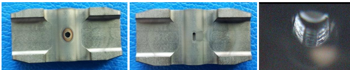
Abbildung 65: langsam alterndes Graphitrohr mit 105 Heizzyklen.
