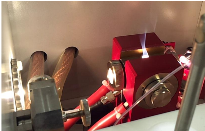
Abbildung 34: Extreme Rauchbildung beim Atomisieren durch ein ungeeignetes Ofenprogramm.
