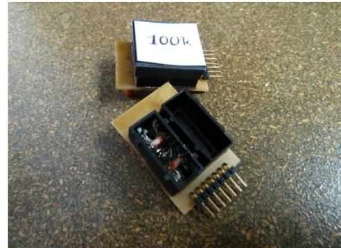
Abb: B.2.: Potentiometermodul s101 komplett und teilbestückt
