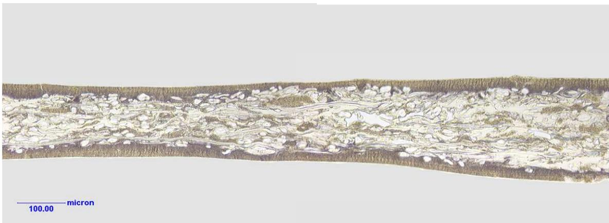
Abbildung 6.16: Mikrotomschnitt von Papier ohne Gripper-Slip-Erscheinung (200x)
