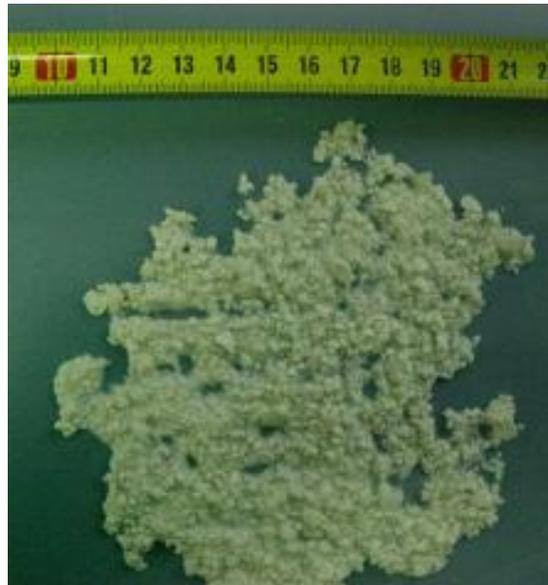
**Abbildung 7.2** – Rückstand in der Kalkmilch der Versuche M7146 bis M7152 mit Eigenkalk
