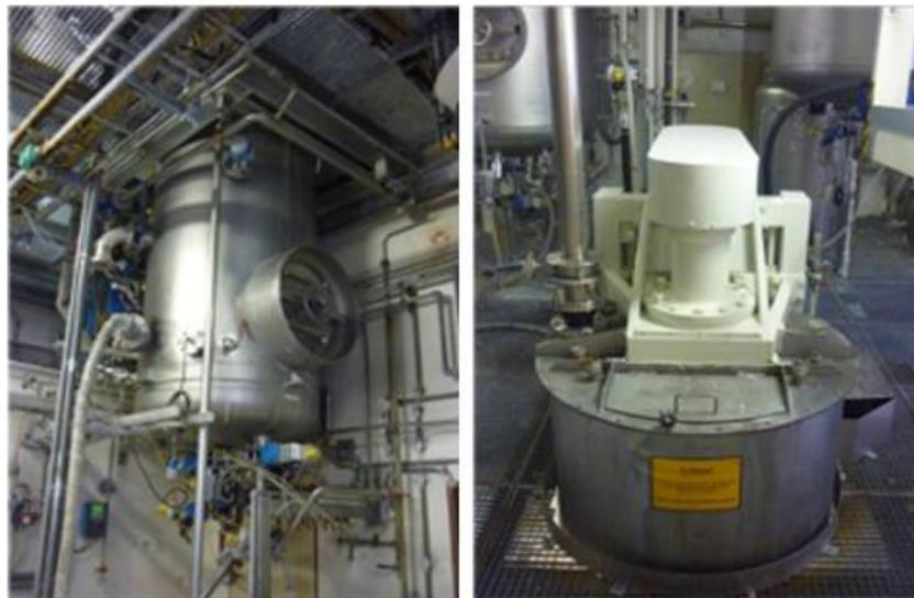
**Abbildung 7.4** – Pilotreaktor (links) und Ultramill (UM) (rechts)
