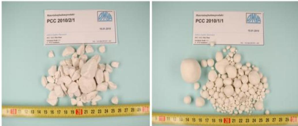
Abbildung 5.4 – Granularität von Taggerkalk (links) und Eigenkalk von Mondi Frantschach (rechts)
