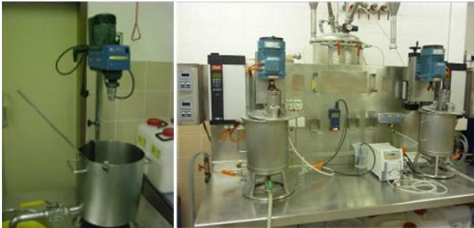
**Abbildung 7.1** – Löschkessel zur Kalkmilchherstellung (links) und Versuchsstand zur CCC-Herstellung (rechts)
