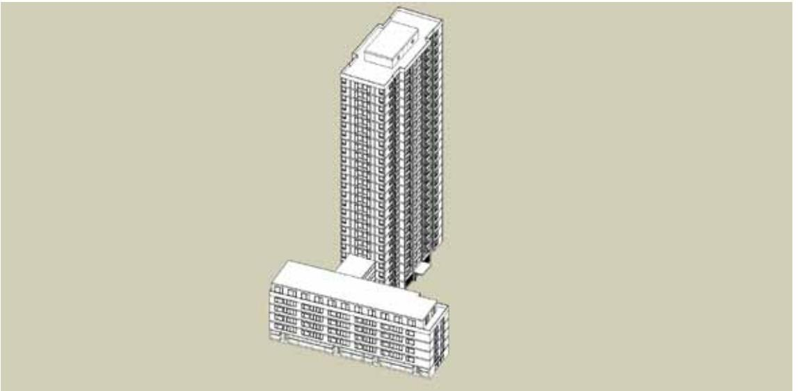
Die gezeigten Pläne beschreiben das statische Grundkonzept über die Stützen, die sich im äußeren Bereich des Gebäudes befinden. Sie sind im weiteren Kräfteverbund mit den Geschossdecken und äußeren STB-Trägern mit dem Gebäudekern, der die Treppenanlagen sowie haustechnischen Anlagen, verbunden.
