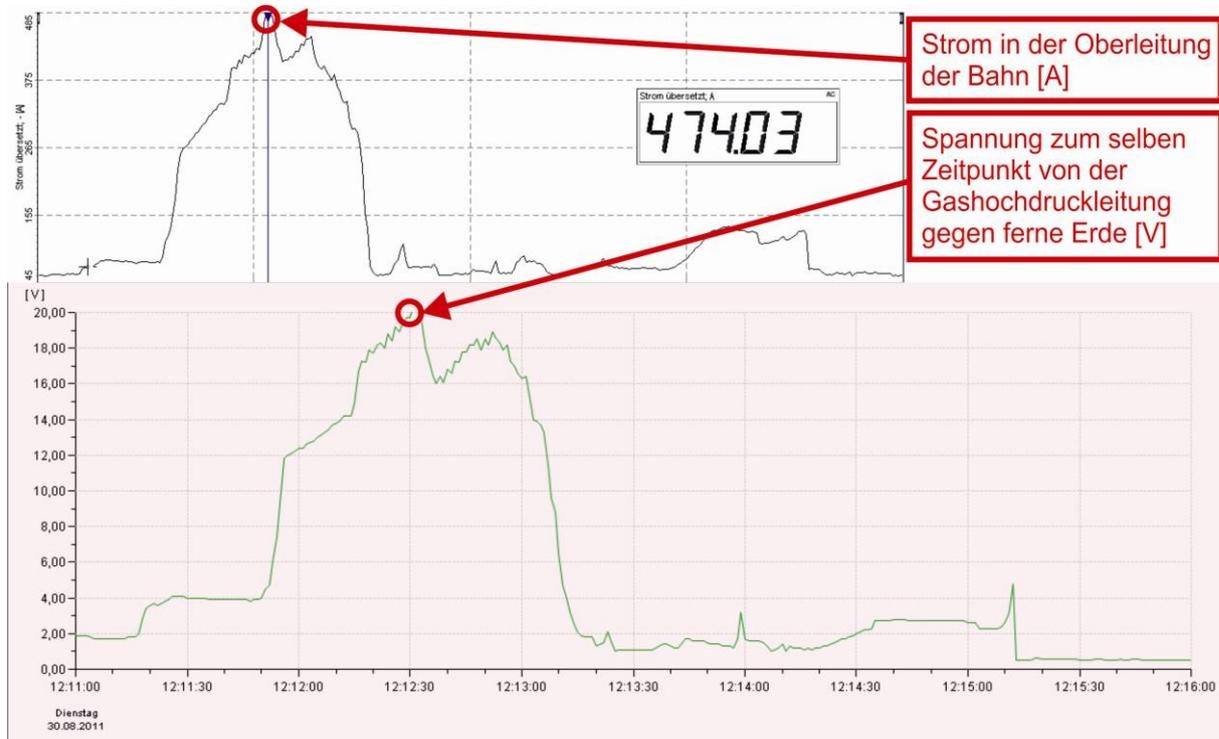
**Abbildung 7.2:** Verlauf des beeinflussenden Stroms im Bahnsystem im Vergleich mit dem Spannungsverlauf der Gashochdruckleitung gegen ferne Erde
