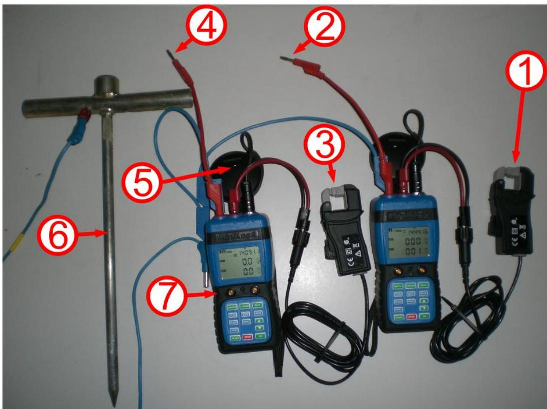
Abbildung 6.12: Messequipment zur Erfassung der Spannungen und Ströme entlang Rohrleitung und Begleitkabel mittels Datalogger
