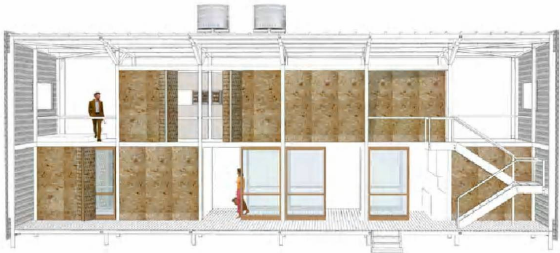
Abb. 1.2.4.10 | LÄNGSSCHNITT MIT GESCHLOSSENEN OSB-ELEMENTEN
