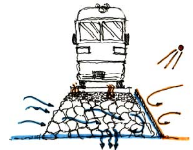
Abb. 1.1.3.11 UNTERLÜFTUNG MIT SONNENSCHUTZ
