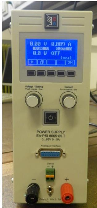
Abbildung 110: Das steuerbare Netzgerät
